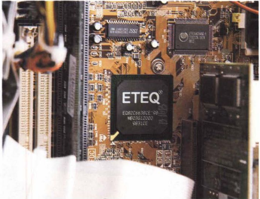
Il chipset utilizzato dalla Soyo sulla SY-5HEM è marchiato ETEQ. Non siamo riusciti a reperire informazioni certe sulla provenienza dei chip né sul costruttore. Resta il fatto che il sistema si comporta benissimo, anche a frequenze superiori a quelle ufficiali (100 MHz).
